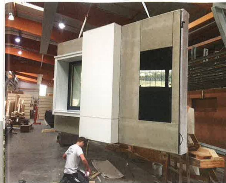
Vorfertigung des Fassadenfunktionsmusters in der Werkhalle der Kulmer Holz-Leimbau GesmbH.
