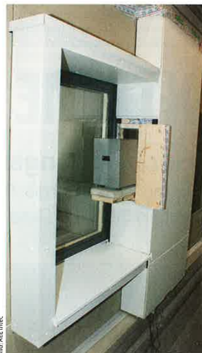
Frontale Ansicht des gesamten Fassadenfunktionsmusters mit integriertem Gebäudetechnischschatz (Mitte), Fenster inkl. Zuluftelement (links) und Photovoltaikmodul (rechts).
