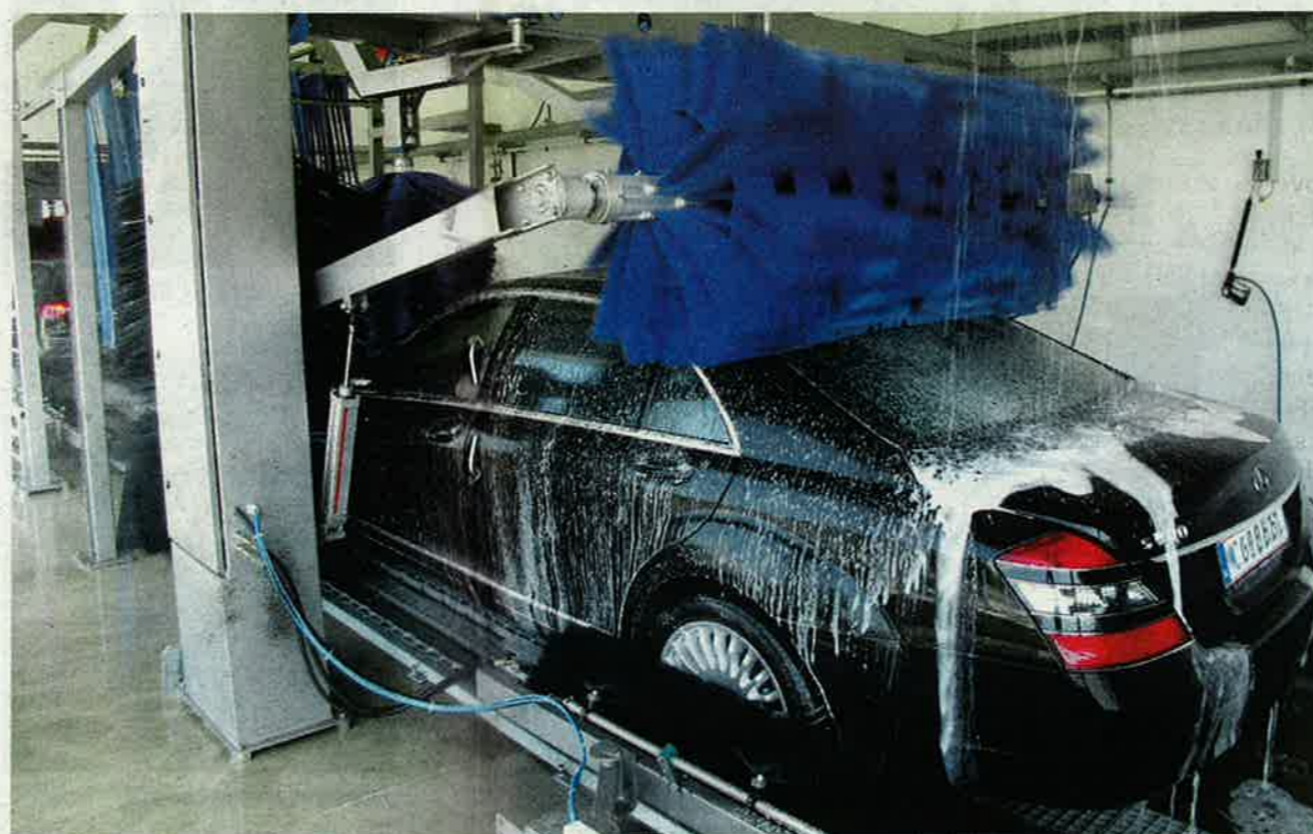
Nachdem sich ein Hochdruckroboter am Fahrzeug zu schaffen gemacht hat, sorgen Walzen mit Mikrofasertextilien und zahlreiche weitere Reinigungsstationen der 50 Meter langen Waschstraße für ein blitzblankes Auto. Foto: KK.
